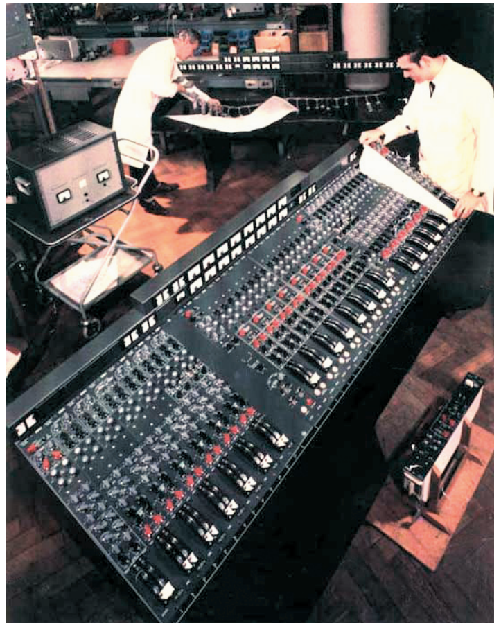
Die TG Mk1 Transistor-Konsole löste die Röhrentechnik ab
