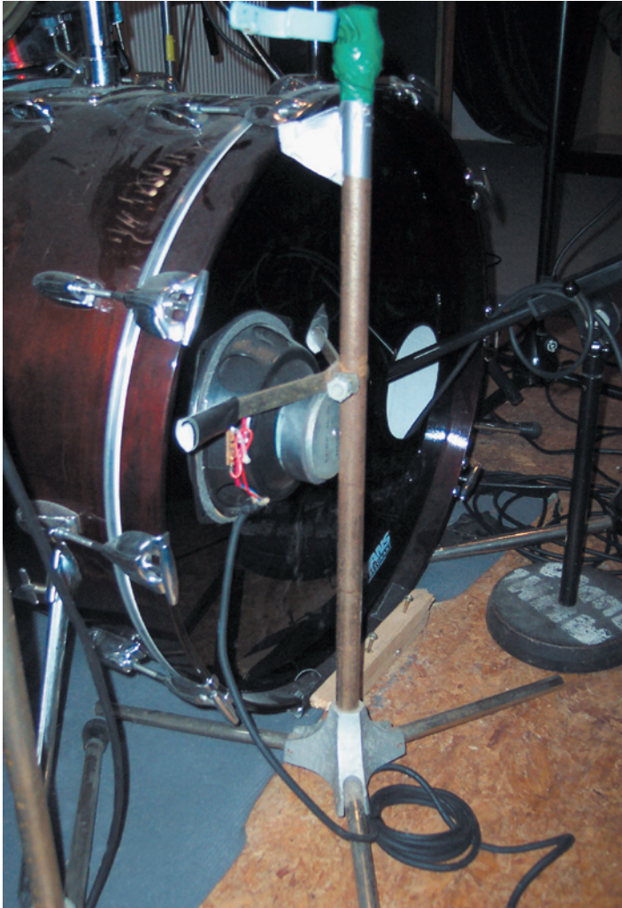
Lautsprecher als Mikrofon zur Bassdrum-Abnahme
