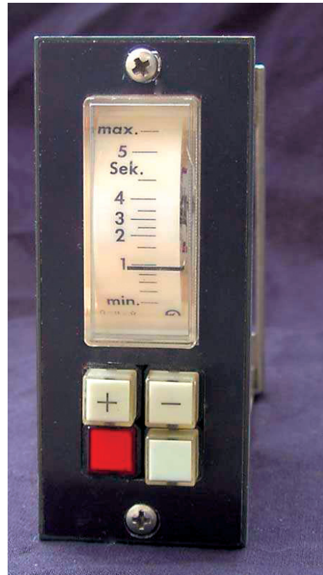
Mit der EMT 140 Remote steuerte man den Stellmotor des Dämpfungsmechanismus
